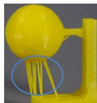
图 5 3D 打印支撑结构
