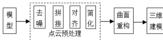
图 6 3D 扫描流程图
